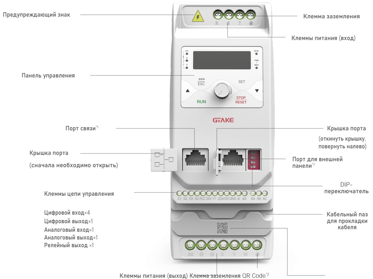
\*1: Поддерживаются два сетевых порта, и многоуровневая связь по RS-485. Стандартный сетевой кабель и максимальное расстояние связи до 3 метров.
