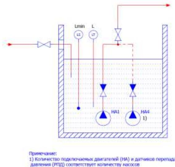
Рис. 5. Канализационная станция.
