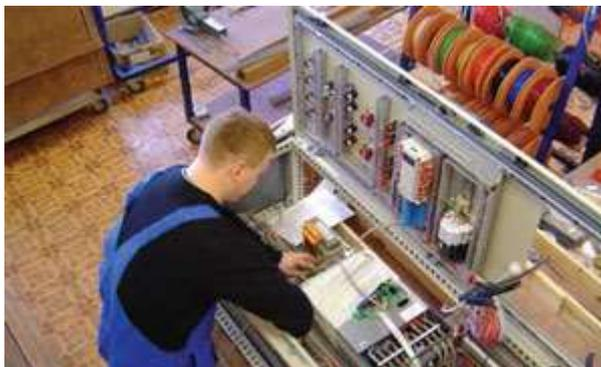
Разработкой схемотехнических решений и программного обеспечения занимается проектное подразделение ООО «ПРИВОД-ИНЖИНИРИНГ». Сборка шкафов автоматики осуществляется на собственном производстве, расположенном в г. Истра Московской области. Все собранные системы управления проходят строгий технический контроль и тестирование на специальном стенде, имитирующем работу насосной станции.
