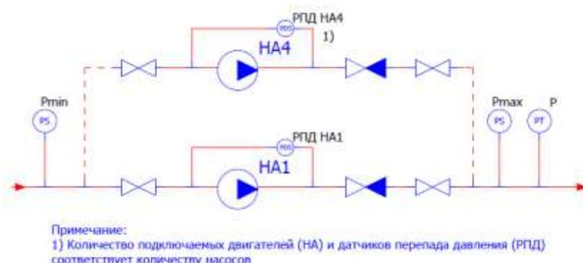
Рис. 4. Станция 3-го подъёма (повысительная).
