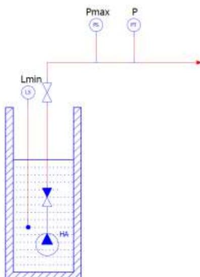
Рис. 1. Станция 1-го подъёма с погружным насосом.
