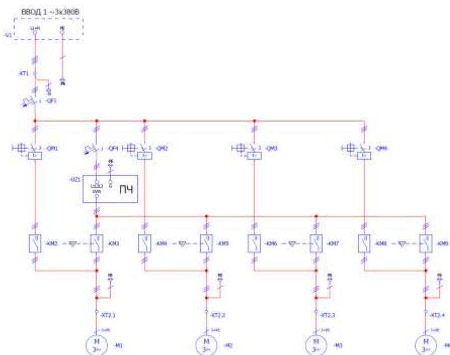
Рисунок 1. Однолинейная схема СРНУ-М на 4 насоса.
