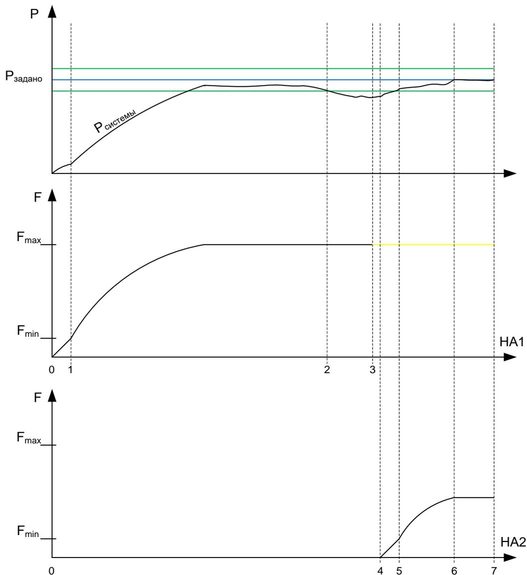
Рисунок 3. Циклограмма работы насоса с подключением дополнительного насоса
