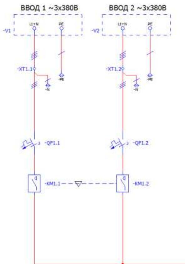
Рисунок 4. Схема АВР
